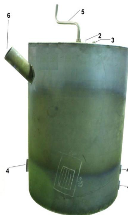
**Рисунок 1** – Биореактор БУГ-Р
