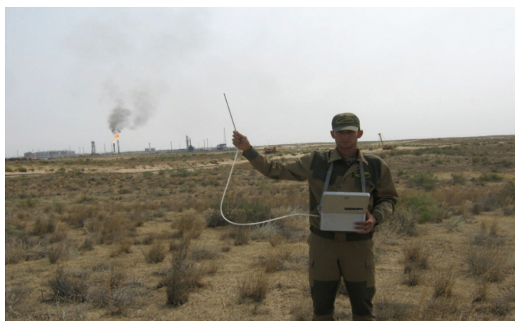
Рисунок 1 – Отбор проб воздуха на газоанализаторе «Ганг -4»
