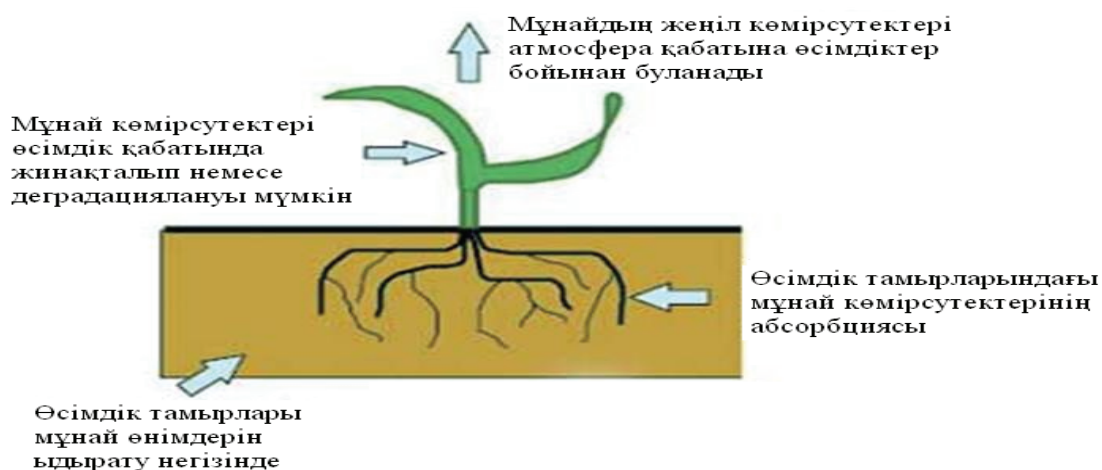
1-сурет – Мұнай және мұнай өнімдерімен ластанған топырақтардың фиторемедиациясы кезіндегі негізгі механизмдері
